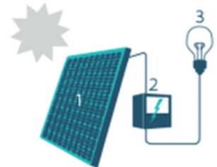
1. Zonnepaneel | 2. Omvormer | 3. Elektrische toestellen
